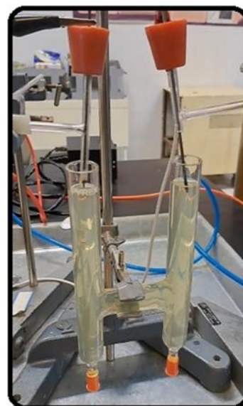
شکل 1. چیدمان راکتور هافمن جهت اعمال پلاسما.
